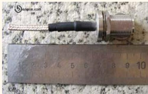
**3 Separar el vivo de la malla** del cable y doblar ambos 90 grados en sentidos opuestos. Cortar los extremos del vivo y de la malla de forma que queden con una medida de 27 mm. cada uno
