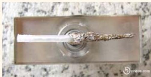
**7 Fijar el iluminador "DeY"** que hemos construido en el soporte del LNB para que quede situado en el foco de la parábola y ya tenemos antena.
