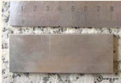
**6 Taladrarla** en el centro con una broca del diámetro del conector. Esta lámina será el reflector del dipolo por lo que la fijaremos al conector mediante las tuercas del mismo.
